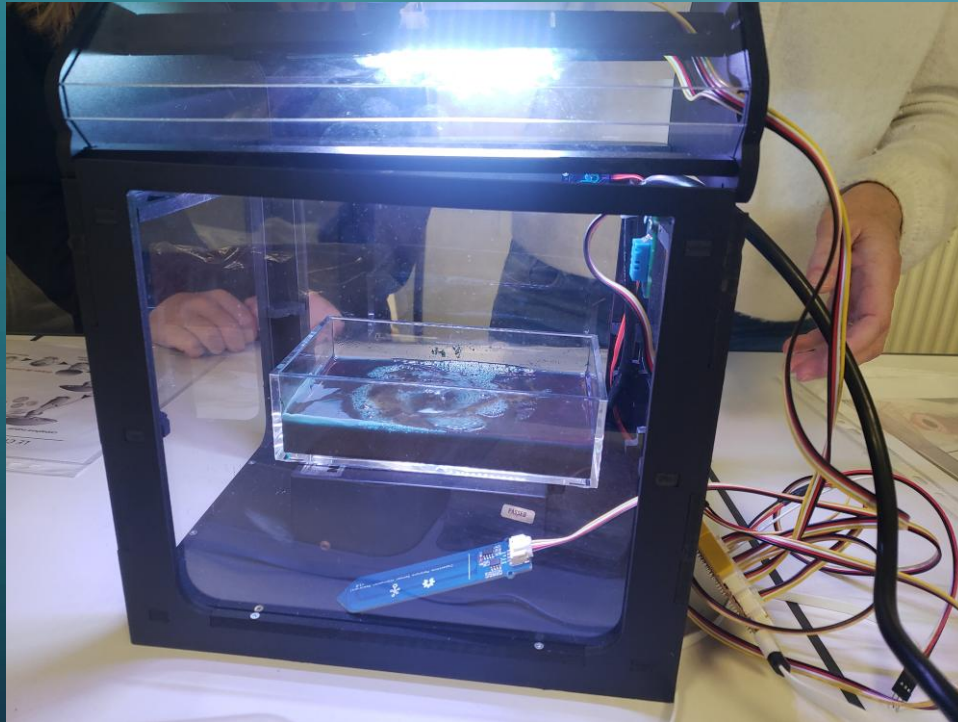
Mini-serre montée, avec la culture de spiruline dans le bas
