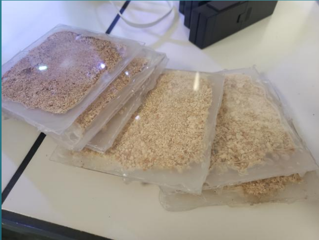
La poudre de mycélium est placée entre 2 plaques de plexiglass.
